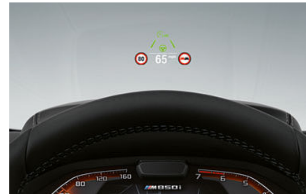
WYŚWIETLACZ BMW HEAD-UP WSKAZUJE INFORMACJE ISTOTNE PODCZAS JAZDY W BEZPOŚREDNIM POLU WIDZENIA KIEROWCY.
